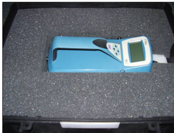
Figure 52 : Mise en place du P-Track calé par des blocs de mousse dans une « valise 19 ».
