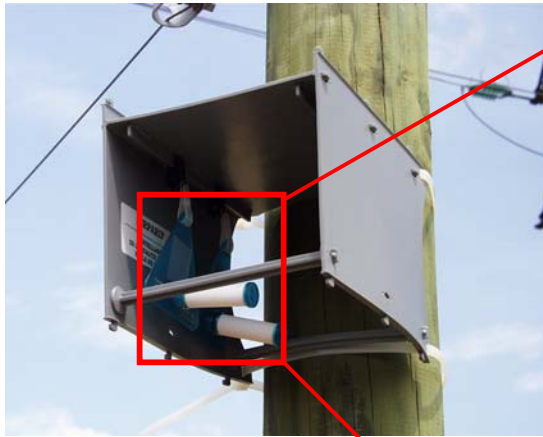
Figure 4 : Échantillonneurs passifs pour le benzène installés à l'intérieur de l'abri de protection.
