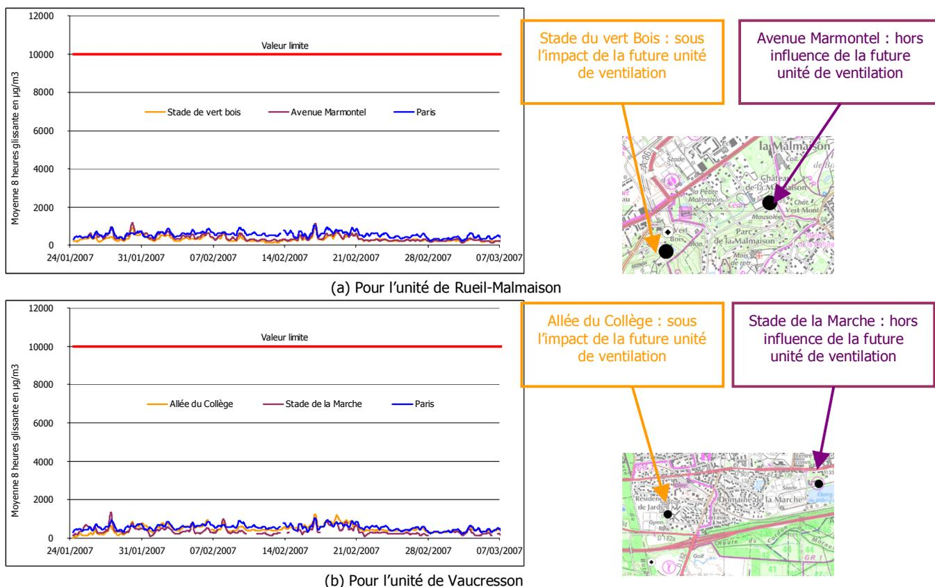
**Figure 39** : Evolution de la concentration moyenne en CO sur huit heures aux sites temporaires instrumentés aux voisinages des unités de ventilations lors de la campagne de mesure.
