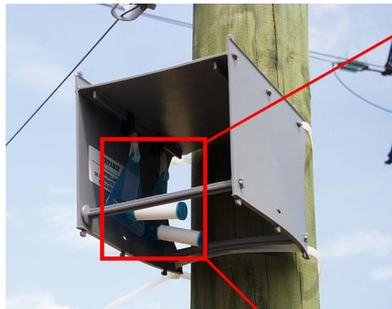
Figure 4 : **Echantillonneurs passifs pour le benzène installés à l'intérieur de l'abri de protection.**
